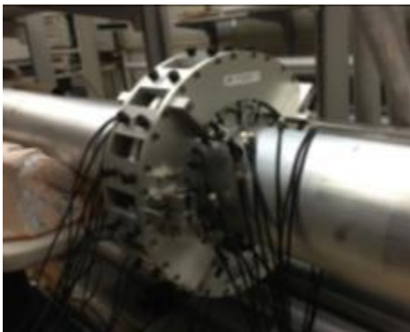
FIG. 2 配管検査用圧電式ガイド波センサー (世界標準方式2種類を国内で唯一保持している)
